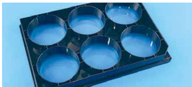
▲ 6wellマイクロプレート (PDMS貼付) の貼り合わせ例
